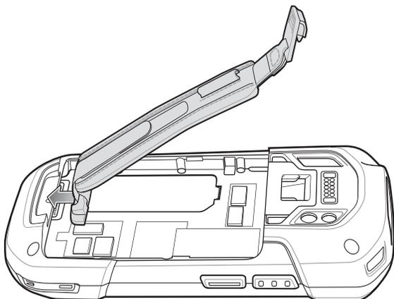
3. Inserire prima la parte inferiore della batteria nell'apposito vano batteria, situato sul retro del dispositivo.
