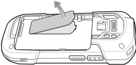
Figura 3 Posizioni degli slot SIM di TC77
