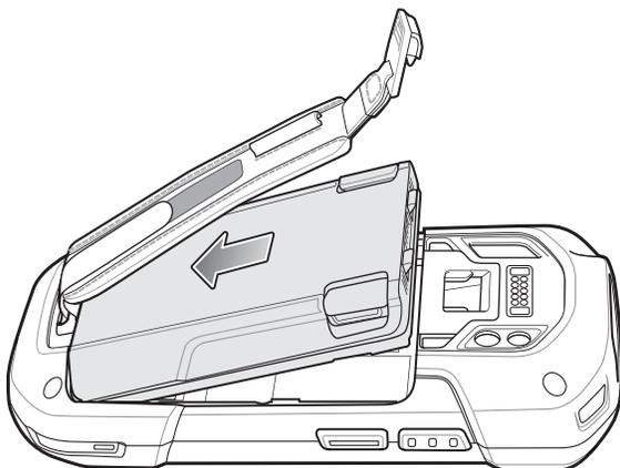
4. Spingere la batteria all'interno del vano batteria, finché le linguette di sblocco non scattano in posizione.
