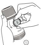
13 Desbloquee el pistón de su posición de viaje.
