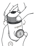
10 Enrosque firmemente la cabeza de salida en el cuerpo principal.
