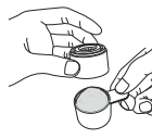
7 Stellen Sie den Filterkorb auf die Oberseite der Schaufel.
