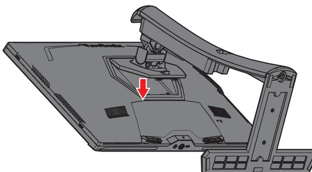
5. Fissare la staffa di montaggio ai fori di montaggio VESA sul retro del monitor. Quindi fissarlo con le quattro (4) viti (M4 x 10 mm).
