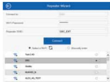
Completare l'inserimento, quindi cliccare sul pulsante "Connect". Dopo che il riavvio è stato completato, si prega di andare alle impostazioni WLAN del dispositivo, collegarsi al nuovo Wi-Fi SSID.
