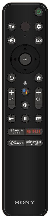
Parlare qui per utilizzare il microfono nel telecomando. È presente un LED sopra il microfono.
