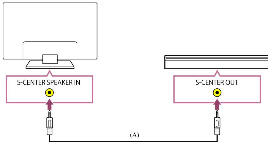
(A) Cavo per la modalità altoparlante centrale TV (in dotazione con sound bar dotate di terminali S-CENTER OUT)
