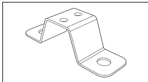
Nel caso di collegamento tramite cavo da 10 mm quadrati di sezione interna, per un corretto fissaggio dello stesso, è necessario sostituire il cavalotto già installato con il cavalotto in
