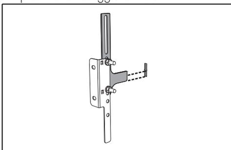
5. Allineare la base della staffa di fissaggio fino a a terra e stringere le viti per fissare le misure.
