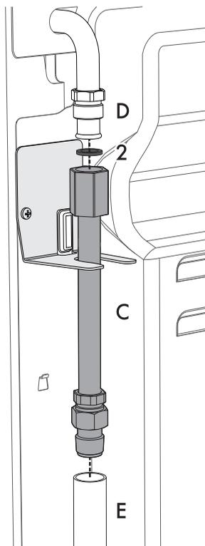
5. Applicare del materiale isolante sul filetto della prolunga assemblata **C**, dopodiché avvitare il tubo flessibile **E**.
