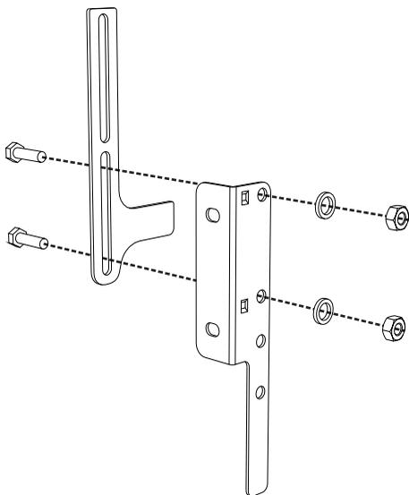
4. Allineare la base del gancio della staffa di fissaggio con la base del taglio della piastrina di fissaggio al muro.
