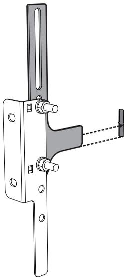
5. Allineare la base della staffa di fissaggio fino a terra e stringere le viti per fissare le misure.
