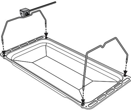
3. Utilizzare le forchette a clip in dotazione per preparare l'asta girarrosto. È possibile bloccare le forchette tramite le viti di fissaggio.
