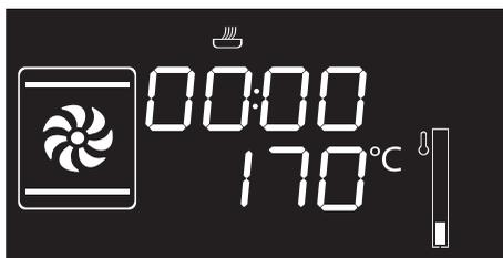
2. Ruotare la manopola a destra o a sinistra per impostare la durata di cottura da 00:01 a 12:59. Mantenere ruotata la manopola per avere un incremento o una diminuzione veloce.
