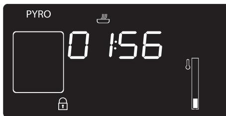
1. Sul display appare la dicitura **PYRO ECO** o **PYRO ECO** ed il tempo restante ad indicare che l'apparecchio sta effettuando il ciclo di pulizia automatico.
