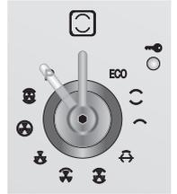
Trascorsi due minuti dall'inizio del ciclo di pulizia (Pirolisi) interverrà un dispositivo di blocco porta che impedirà l'apertura della porta stessa. L'intervento di questo blocco è segnalato dall'accensione dell'apposita spia.
