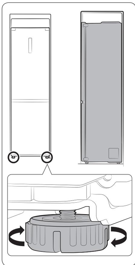
5. Regolare i piedini di livellamento in modo da mantenere il prodotto e l'armadiatura allineati.
