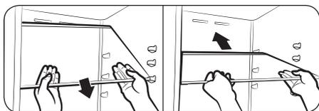
4. Durante l'estrazione verso l'alto e avanti del lato anteriore, inserire il lato posteriore nei supporti posteriori.
