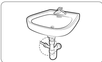
1. Montare il connettore del tubo (A) e fissarlo all'estremità del tubo accessorio come mostrato in figura.
