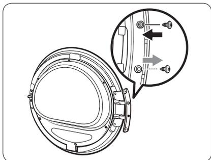
11. Rimuovere la vite sulla parte inferiore della cerniera dello sportello e fissarla sulla parte superiore della cerniera dello sportello.
