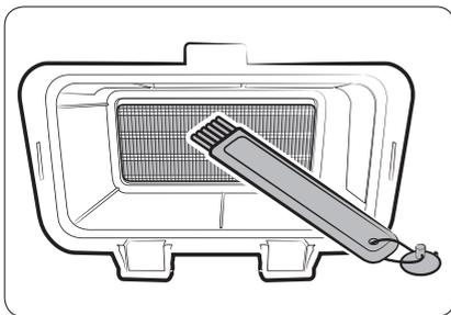
4. Pulire lo scambiatore di calore con la spazzola in dotazione o un aspirapolvere dotato di spazzola. Prestare attenzione a non piegare o danneggiare le alette dello scambiatore di calore durante la pulizia. Ciò infatti potrebbe portare ad un peggioramento della capacità di asciugatura.
