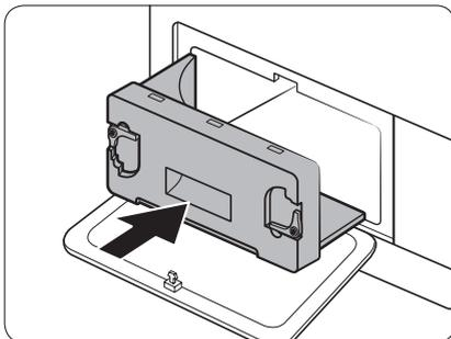
6. Rimontare il coperchio interno nella sua posizione originale e chiudere le leve di fissaggio.
