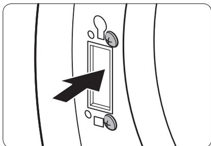
10. Serrare le 2 viti rimosse nel passaggio 8 dal telaio della cerniera sul lato opposto. Notare che è necessario serrarli sulla destra (in alto a destra e in basso a destra) del telaio.
