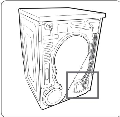
L'asciugatrice viene fornita in dotazione con un serbatoio incorporato. Tuttavia, qualora non si desideri utilizzarlo, è possibile installare il tubo di scarico. Il tubo di scarico, accessorio in dotazione (tubo di scarico lungo), può essere utilizzato come una prolunga del tubo di scarico.
