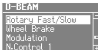
2. Ruotate la manopola [VALUE] per selezionare l'effetto sonoro o la funzione che volete controllare usando il D-BEAM controller.
