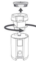
3. Leeren Sie den Staubbehälter und verwenden Sie die Reinigungsbürste, um Filter und Zyklon zu reinigen. Waschen Sie beides unter fließendem Wasser. Lassen Sie sie mindestens 24 Stunden an der Luft trocknen, bevor Sie sie wieder einbauen.
