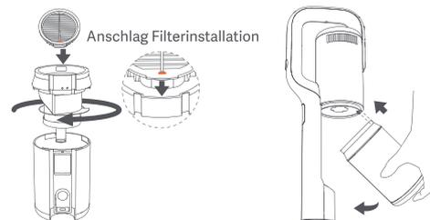
→ Wir empfehlen, den Filter alle 3 Monate zu wechseln, um die höchste Effizienz zu gewährleisten. Verwenden Sie nur vom Hersteller empfohlene Filter.
