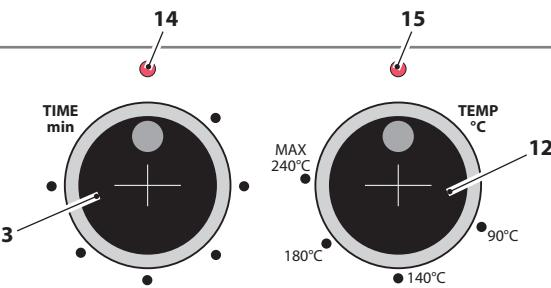
Durante la cottura la spia luminosa (15) si accende e si spegne evidenziando che il termostato sta mantenendo la temperatura impostata.
