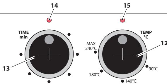
Beim Garen schaltet sich die Kontrolllampe (15) ein und aus, um anzudeuten, dass der Thermostat die eingegebene Temperatur hält.
