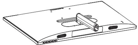
2. (1) Tenere la base con entrambe le mani ed inserire saldamente la base nel supporto.
