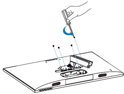
2. Usare il cacciavite per allentare la vite situata nella parte inferiore della base e rimuovere la base dal supporto.
