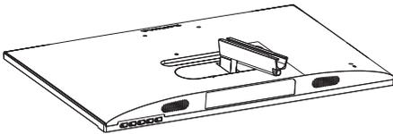
2. (1) Tenere la base con entrambe le mani ed inserire saldamente la base nel supporto.
