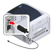
Inserire un'estremità del cavo USB nel connettore di interfaccia USB nella periferica.
