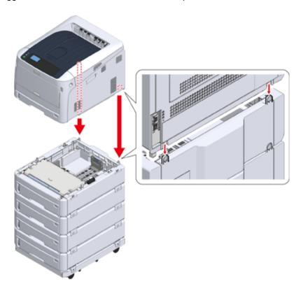
Quando si attacca l'unità cassetto ulteriore, collegare l'unità stampante e l'unità cassetto ulteriore.
