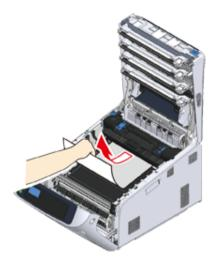
Sollevare la leva di bloccaggio sinistra (5) dell'unità fusore.
