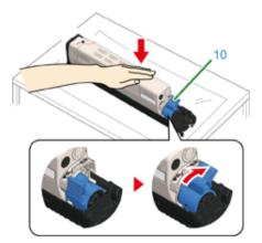
Controllare il colore dell'etichetta del nuovo tamburo fotosensibile e inserire il tamburo nel dispositivo.
