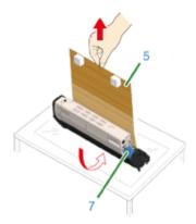
Mettere il tamburo con la pellicola protettiva rimossa nella stampante e ruotare la leva di bloccaggio della cartuccia di toner (7) (blu) nella direzione della freccia per allinearla con ▶.
