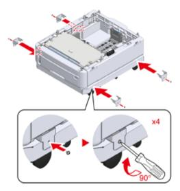
Quando si aggiunge un'ulteriore unità vassoio aggiuntiva, posizionare delicatamente l'unità sopra in modo che le protuberanze sul retro dell'unità
