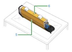
(2) Trascinare la pellicola protettiva (5) nella direzione della freccia. Non ruotare la leva di bloccaggio della cartuccia di toner (7) (blu).
