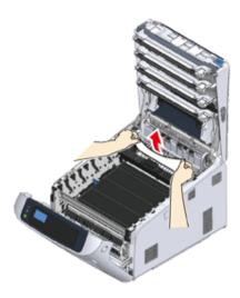
Afferrare l'impugnatura dell'unità fusore (6) e inserire l'unità nel dispositivo.
