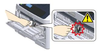
Aprire il coperchio del rullo di separazione (6) in avanti premendo sulla parte centrale del vassoio MU.
