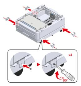
4 Allinea il retro dello strato inferiore dell'unità Cassetto ulteriore con la sporgenza sul retro del cassetto supplementare da montare e impilali delicatamente.
