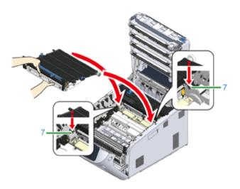
Tieni le leve di bloccaggio della cinghia e imposta la cinghia per la macchina.
