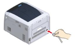
Inserire il cavo di alimentazione nella presa di corrente.
