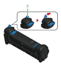
Mantenere l'impugnatura e porre il nuovo fusore nel dispositivo.
