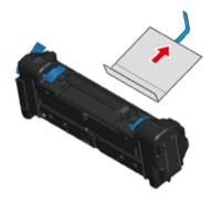
Tirare la leva di bloccaggio sinistra (5) dell'unità fusore.
