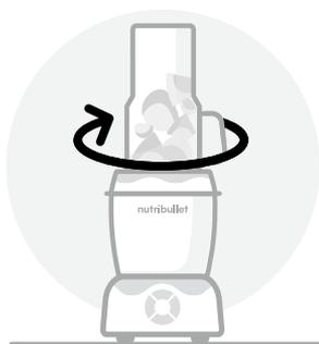
Capovolgere il bicchiere e posizionarlo sulla base motore; ruotare il bicchiere in senso orario per bloccarlo in posizione.
