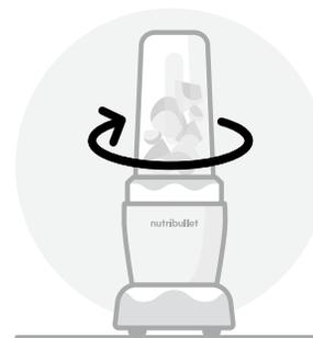
Inversez la tasse et placez-la sur la base moteur en la tournant délicatement dans le sens horaire pour la verrouiller dans la base moteur. Ceci active le cycle d'extraction.
