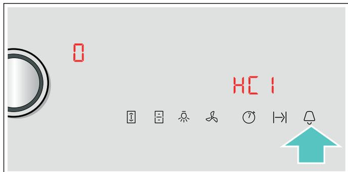
4. Con il selettore Tipp impostare il valore **1** "collegamento automatico" oppure il valore **2** "collegamento manuale".
