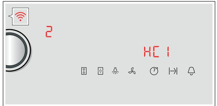
5. Registrare un dispositivo mobile nella rete del piano cottura con la SSID "HomeConnect" con la key "HomeConnect".
