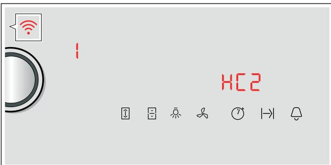
6. Avviare l'app sul dispositivo mobile e seguire le istruzioni per la registrazione automatica nella rete. La procedura di registrazione è terminata quando sull'indicatore delle zone di cottura viene visualizzato il valore
