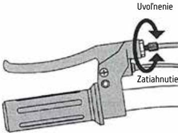
1. Pre nastavenie brzdového káblíka otáčajte doprava (uvoľnenie) alebo doľava (zatiahnutie) regulačným valčekom na brzdovej páke. Otáčajte valčekom po troškách, kým nedosiahnete požadované nastavenie. Ak si brzda vyžaduje ďalšie nastavenia, pokračujte v nasledujúcom kroku.
