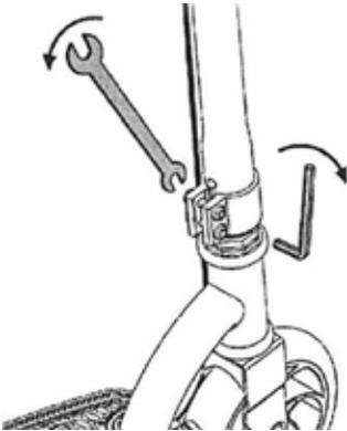
2. Ziehen Sie die Schrauben mit dem 5-mm-Inbusschlüssel und dem 10-mm-Schlüssel fest. Ziehen Sie die Schrauben gleichmäßig und sicher an.
