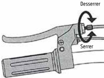
1. Pour régler le fil du câble de frein, tournez dans le sens horaire (desserrer) ou dans le sens antihoraire (serrer) le cylindre de réglage sur le levier de frein. Tourner le cylindre un peu à la fois, jusqu'à ce que le réglage souhaité soit atteint. Si le frein nécessite de réglages ultérieurs, passez à l'étape suivante.
