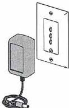
2. Collegare il caricabatterie ad una presa di alimentazione. La luce presente sul caricabatterie dovrebbe illuminarsi. Una luce a LED rossa indica che la batteria è in carica e una luce a LED verde indica che la batteria è completamente carica.
