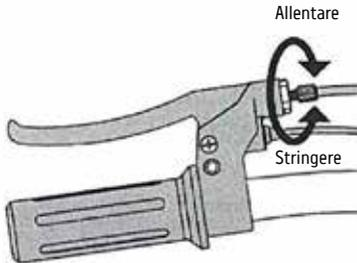
1. Per regolare il filo del cavo del freno girare in senso orario (allentare) o in senso antiorario (stringere) il cilindro di regolazione sulla leva del freno. Ruotare il cilindro solo poco per volta, fino a raggiungere la regolazione desiderata. Se il freno continua a necessitare di ulteriori regolazioni, procedere al passaggio successivo.
