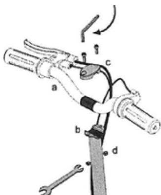
3. Zarovnejte řídítka jak svisle, tak vodorovně (a) na svorku hlavové trubky (b), namontujte svorku řídítek a komponenty (c a d) a rovnoměrně a pevně utáhněte 5mm imbusovým klíčem a 10mm klíčem.
