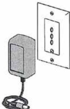
2. Conecte o carregador de bateria a uma tomada de alimentação. A luz presente no carregador de bateria deve se iluminar. Uma luz em LED vermelha indica que a bateria está em carga, e uma luz em LED verde indica que a bateria está completamente carregada.
