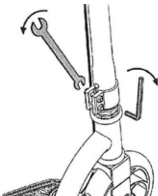
2. Serrer les boulons avec la clé hexagonale de 5 mm et la clé de 10 mm. Serrer les boulons uniformément et solidement.
