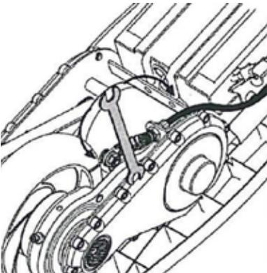
2. Εάν το καλώδιο του φρένου εξακολουθεί να είναι πολύ σφιχτό ή πολύ χαλαρό, χρησιμοποιήστε ένα κλειδί των 10 mm για να χαλαρώσετε το μπουλόνι σύσφιξης του καλώδιου του φρένου για περαιτέρω ρύθμιση στο καλώδιο. Βεβαιωθείτε ότι το παξιμάδι των 10 mm είναι καλά σφιγμένο μετά τη ρύθμιση.
