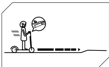
Cominciare a frenare ad una distanza sufficiente da evitare ostacoli, curve e zone che differiscono in quanto a pavimentazioni. Ricordarsi di lasciare andare l'acceleratore prima di frenare.
