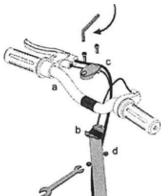
3. Alinhe o guidão tanto verticalmente quanto horizontalmente (a) no cerra-cabo do tubo de esterço (b), instale o cerra-cabo do guidão e os componentes (c e d) e aperte uniformemente e com firmeza com a chave hexagonal de 5 mm e a chave de 10 mm.
