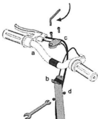
3. Alinear el manubrio tanto vertical como horizontalmente (a) al terminal del tubo de la dirección (b), instalar el terminal del manubrio y los componentes (c y d) y apretar uniforme y firmemente con la llave hexagonal de 5 mm y la llave de 10 mm.
