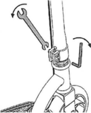
2. 5 mm šesťhranným kľúčom a 10 mm kľúčom dotiahnite skrutky s maticami. Dotiahnite ich jednotne a bezpečne.
