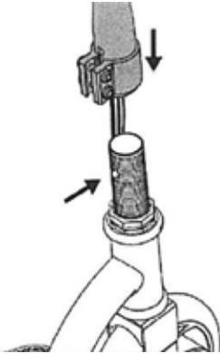
1 Drücken Sie den Knopf an der Rückseite der Gabel und setzen Sie das Lenkersteuerrohr des Lenkers auf die Gabel. Der Knopf sollte mit dem Positionierungsloch im Lenker-Steuerrohr ausgerichtet sein, um das Steuerrohr sicher einrasten zu lassen.
