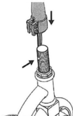
1. Premere il pulsante situato sul retro della forcella e inserire il tubo dello sterzo del manubrio sulla forcella. Il pulsante deve allinearsi con il foro di posizionamento nel tubo dello sterzo del manubrio e bloccare saldamente il tubo dello sterzo in posizione.
