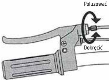
1. W celu wyregulowania linki hamulca przekręć pokrętko regulacyjne na dźwigni hamulca w prawo (poluzuj) lub w lewo (dokręć). Przekręcaj pokrętko po trochu, aż do uzyskania żądanej regulacji. Jeżeli hamulec wymaga dodatkowej regulacji, przejdź do następnego punktu.
