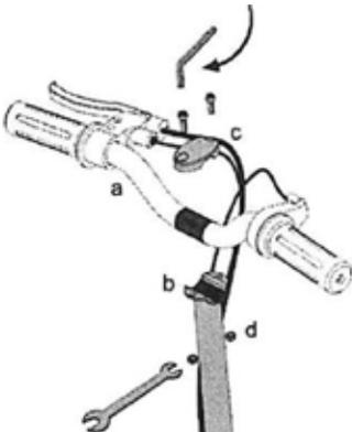
3. Kormidlo zarovnajte v zvislom aj horizontálnom smere (a) na svorke rúry otáčania (b), inštalujte svorku kormidla a komponenty (c a d) a jednotne a napevno dotiahnite 5 mm šesťhranným kľúčom a 10 mm kľúčom.
