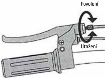
1. Pro regulaci drátu brzdového lanka otočte seřizovacím válcem na brzdové páčce ve směru hodinových ručiček (povolení) nebo proti směru hodinových ručiček (utažení). Otáčejte válcem jen po kouskách, dokud není dosaženo požadovaného nastavení. Pokud brzda i nadále vyžaduje další seřízení, pokračujte dalším krokem.
