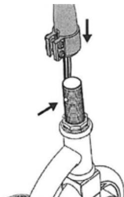
1. Πατήστε το κουμπί που βρίσκεται στο πίσω μέρος του διχαλωτού στηρίγματος και εισάγετε τον σωλήνα της στήλης του τιμονιού στο διχαλωτό στηρίγμα. Το κουμπί πρέπει να είναι ευθυγραμμισμένο με την οπή εισαγωγής που υπάρχει στο σωλήνα της στήλης του τιμονιού και ασφαλίστε καλά το σωλήνα της στήλης.
