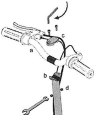
3. Wyrównaj kierownicę w pionie i poziomie (a) na mocowaniu drążka kierownicy (b), zamontuj mocowanie kierownicy i elementy (c i d) oraz dokręć równomiernie i mocno kluczem imbusowym 5 mm i kluczem płaskim 10 mm.
