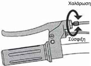
1. Για να ρυθμίσετε το σύρμα του καλώδιου του φρένου περιστρέψτε δεξιόστροφα (χαλάρωση) ή αριστερόστροφα (σύσφιξη) τον κύλινδρο ρύθμισης που υπάρχει στο μοχλό του φρένου. Περιστρέψτε τον κύλινδρο λίγο κάθε φορά, έως ότου επιτευχθεί η επιθυμητή ρύθμιση. Εάν το φρένο εξακολουθεί να χρειάζεται περαιτέρω ρύθμιση, προχωρήστε στο επόμενο βήμα.
