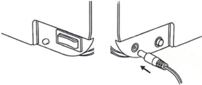
1. Stellen Sie sicher, dass sich der Netzschalter auf der rechten Seite des Trittbretts in der Position "0" befindet, bevor Sie das Ladegerät anschließen. Schließen Sie das Ladegerät an den Ladeanschluss an, der sich auf der linken Seite des Trittbretts befindet. Bewegen Sie den Schalter auf der rechten Seite des Trittbretts in die Position "I"
