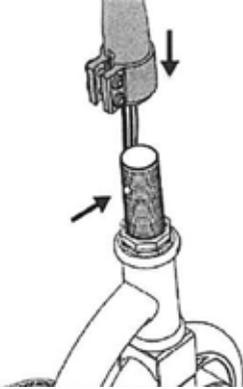
1. Stlačte tlačidlo na zadnej strane sedla a zasuňte rúru otáčania kormidla na sedlo. Tlačidlo sa musí zarovnať s otvorom pre nastavenie polohy v rúre otáčania kormidla a pevne zaistiť rúru otáčania v danej polohe.
