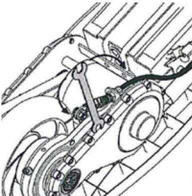
2. Se il cavo del freno è ancora troppo stretto o troppo lento, utilizzare una chiave da 10 mm per allentare il bullone di serraggio del cavo del freno per ulteriori regolazioni sul cavo. Assicurarsi che il dado da 10 mm sia serrato saldamente dopo la regolazione.
