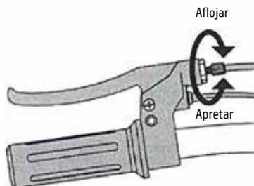
1. Para regular el alambre del cable del freno girar en sentido horario (aflojar) o en sentido antihorario (apretar) el cilindro de regulación en la palanca del freno. Girar el cilindro solo un poco a la vez, hasta alcanzar la regulación deseada. Si el freno necesita regulaciones adicionales, proceder al siguiente paso.
