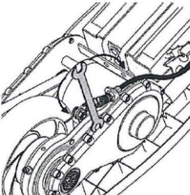
Se o cabo do travão ainda estiver demasiado estreito ou frouxo, utilize uma chave de 10 mm para afrouxar o parafuso de aperto do cabo do travão para fazer regulações adicionais no cabo. Assegure-se de que a porca de 10 mm está firmemente apertada após a regulação.
