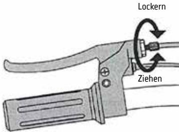
1. Drehen Sie zum Einstellen des Bremskabels den Einstellzylinder am Bremshebel im Uhrzeigersinn (lockern) oder gegen den Uhrzeigersinn (festziehen). Drehen den Zylinder stufenweise nur wenig an, bis die gewünschte Einstellung erreicht ist. Wenn die Bremse noch weiter eingestellt werden muss, fahren Sie mit dem nächsten Schritt fort.
