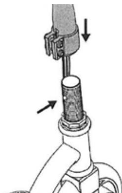
1. Stiskněte tlačítko na zadní straně vidlice a zasuňte na vidlici hlavovou trubku řídítek. Tlačítko musí být v jedné rovině s pozičním otvorem v hlavové trubce řídítek a musí bezpečně zafixovat hlavovou trubku v poloze.
