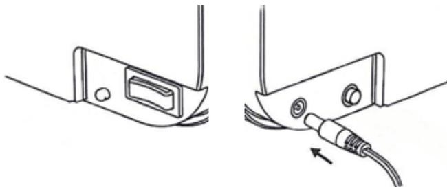
1. Assicurarsi che l'interruttore di alimentazione, nella parte destra della pedana, sia in posizione "0" prima di collegare il caricabatterie. Collegare il caricabatterie alla porta di ricarica, che si trova sul lato sinistro della pedana. Portare l'interruttore nella parte destra della pedana in posizione "I"
