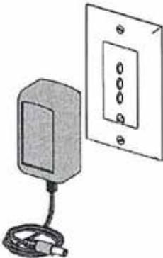
2. Conectar el cargador de baterías a una toma de alimentación. La luz presente en el cargador de baterías debería iluminarse. Una luz de LED roja indica que la batería se está cargando y una luz de LED verde indica que la batería está completamente cargada.
