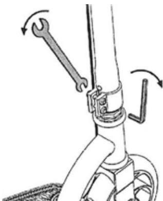
2. Aperte os parafusos com a chave hexagonal de 5 mm e a chave de 10 mm. Aperte os parafusos de modo uniforme e seguro.
