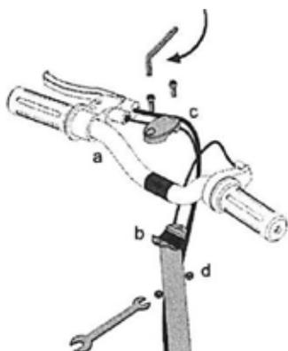
3. Alignez le guidon verticalement et horizontalement (a) sur le collier du tube de la direction (b), installez le collier du guidon et les composants (c et d), et serrez uniformément et fermement avec la clé hexagonale de 5 mm et la clé de 10 mm.
