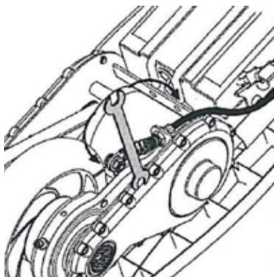
2. Si el cable del freno está todavía demasiado apretado o demasiado flojo, utilizar una llave de 10 mm para aflojar el perno de apriete del cable del freno para regulaciones adicionales en el cable. Asegurarse de que la tuerca de 10 mm esté apretada firmemente después de la regulación.
