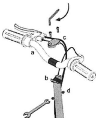
3. Allineare il manubrio sia verticalmente che orizzontalmente (a) sul morsetto del tubo dello sterzo (b), installare il morsetto del manubrio e i componenti (c e d) e serrare uniformemente e saldamente con la chiave esagonale da 5 mm e la chiave da 10 mm.
