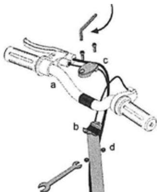
3. Ευθυγραμμίστε το τιμόνι τόσο κάθετα όσο και οριζόντια (a) στον σύνδεσμο του σωλήνα της στήλης (b), τοποθετήστε τον σύνδεσμο του τιμονιού και τα εξαρτήματα (c και d) και σφίξτε ομοιόμορφα και γερά με το εξαγωνικό κλειδί των 5 mm και το κλειδί των 10 mm.
