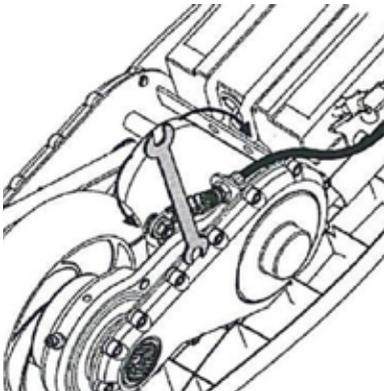
2. Wenn das Bremskabel immer noch zu fest oder zu locker ist, lösen Sie die Klemmschraube des Bremskabels mit einem 10-mm-Schraubenschlüssel, um weitere Einstellungen am Kabel vorzunehmen. Stellen Sie sicher, dass die 10-mm-Mutter nach der Einstellung fest angezogen ist.
