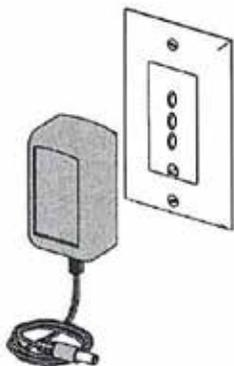
2. Connectez le chargeur à une prise de courant. Le voyant du chargeur de batterie doit s'allumer. Un voyant LED rouge indique que la batterie est en chargement et un voyant LED vert indique que la batterie est complètement chargée.
