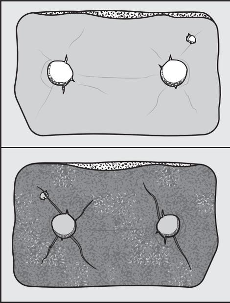
La lanugine passa attraverso le crepe e gli strappi, viene aspirata nello scambiatore di calore. A lungo andare lo scambiatore di calore si blocca.
