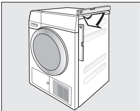
Posizionare l'asciugatrice in bolla affinché funzioni correttamente. Compensare le irregolarità del pavimento utilizzando i piedini.
