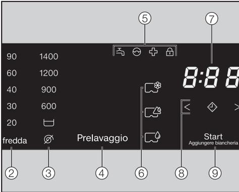
I tasti sensore ②, ③, ④, ⑥, ⑧ e ⑨ reagiscono allo sfioramento con la punta delle dita. La selezione è possibile finché il tasto sensore interessato è illuminato.
