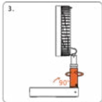
3. Mettere il ventilatore nella posizione desiderata. Fissare l'asta ruotando l'impugnatura di blocco/sblocco in senso orario
