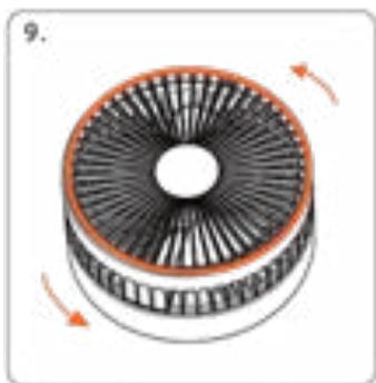
Ruotare la griglia di protezione in senso antiorario e poi rimuoverla
