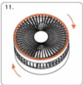
Richiudere ruotando la griglia di protezione in senso orario
