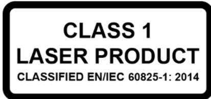
Questo dispositivo è classificato come prodotto laser di classe 1 per *EN/IEC 60825-1:2014*. Questo dispositivo è conforme agli standard delle prestazioni FDA per i prodotti laser, fatta eccezione per la conformità a *IEC 60825-1 Ed. 3*, come descritto in *Notifica laser n. 56*, datata 8 maggio 2019.
