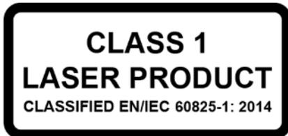
Questo dispositivo è classificato come prodotto laser di classe 1 per *EN/IEC 60825-1:2014*. Questo dispositivo è conforme agli standard 21 CFR 1040.10 e 1040.11, fatta eccezione per la conformità a *IEC 60825-1 Ed. 3.*, come descritto in *Notifica laser n. 56*, datata 8 maggio 2019.
