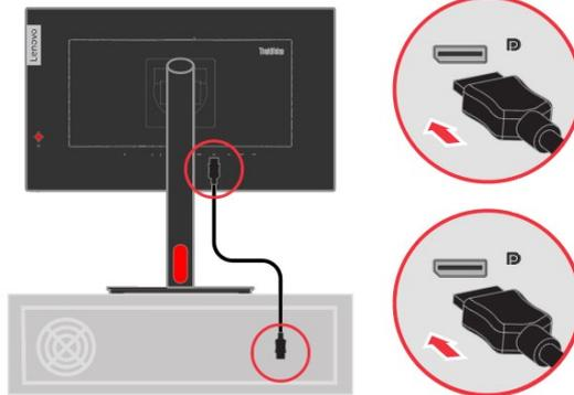
3. Collegare una estremità del cavo HDMI al connettore HDMI sulla parte posteriore del computer e l'altra estremità al connettore HDMI del monitor. Lenovo raccomanda ai clienti che vogliono usare l'ingresso HDMI del monitor di acquistare il "cavo HDMI-HDMI Lenovo 0B47070".
