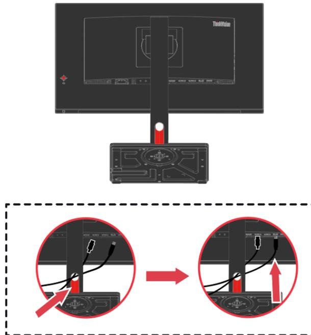
9. Collegare una estremità del cavo DP all'ingresso DP sulla parte posteriore di un altro monitor e l'altra estremità al connettore di uscita DP (per collegamento a catena) del monitor. (Viene adottata la migliore risoluzione (2560 x 1440 a 60 Hz) per garantire il miglior effetto di visualizzazione)
