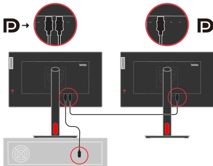
Se si utilizza la funzione Collegamento a catena, quando il 1° P24q-30 utilizza la massima risoluzione, influisce sulla risoluzione di uscita del 2° monitor.
