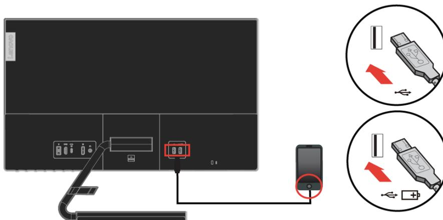
**Nota:** Uscita specifiche di carica della batteria USB 1.2 5 V CC/1,5 A (tipico), 2 A (max) e l'altra uscita USB standard 5 V CC/900 mA. La porta downstream USB non fornisce alimentazione quando il monitor è spento.
