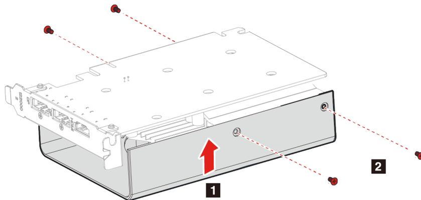
11. Installare la scheda PCI Express nello slot per schede PCI Express, premendo verso il basso fino a quando non si sente uno schiocco dalla linguetta.
