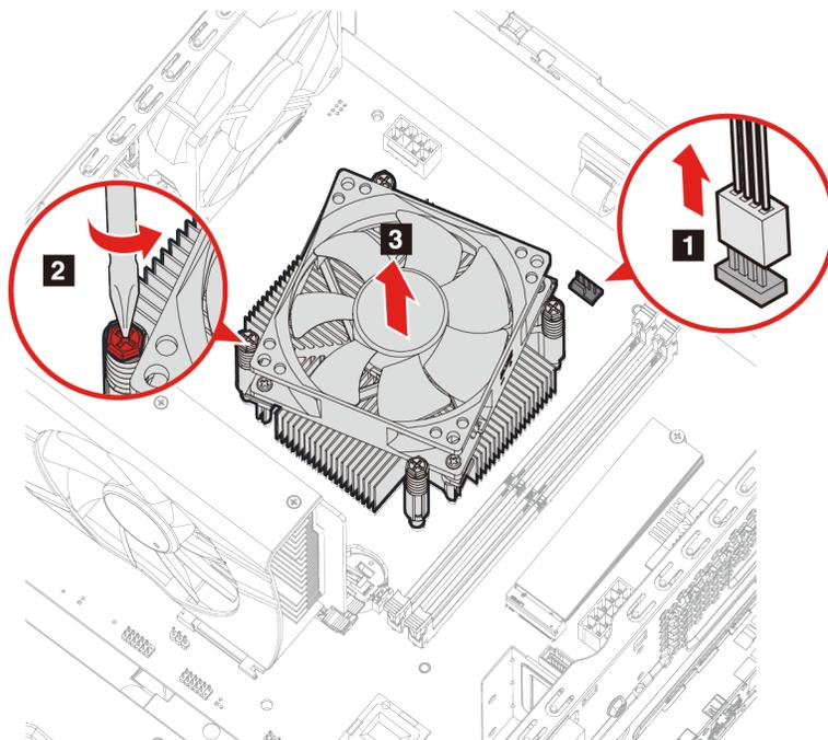
7. Installare il nuovo dissipatore di calore e la ventola.
