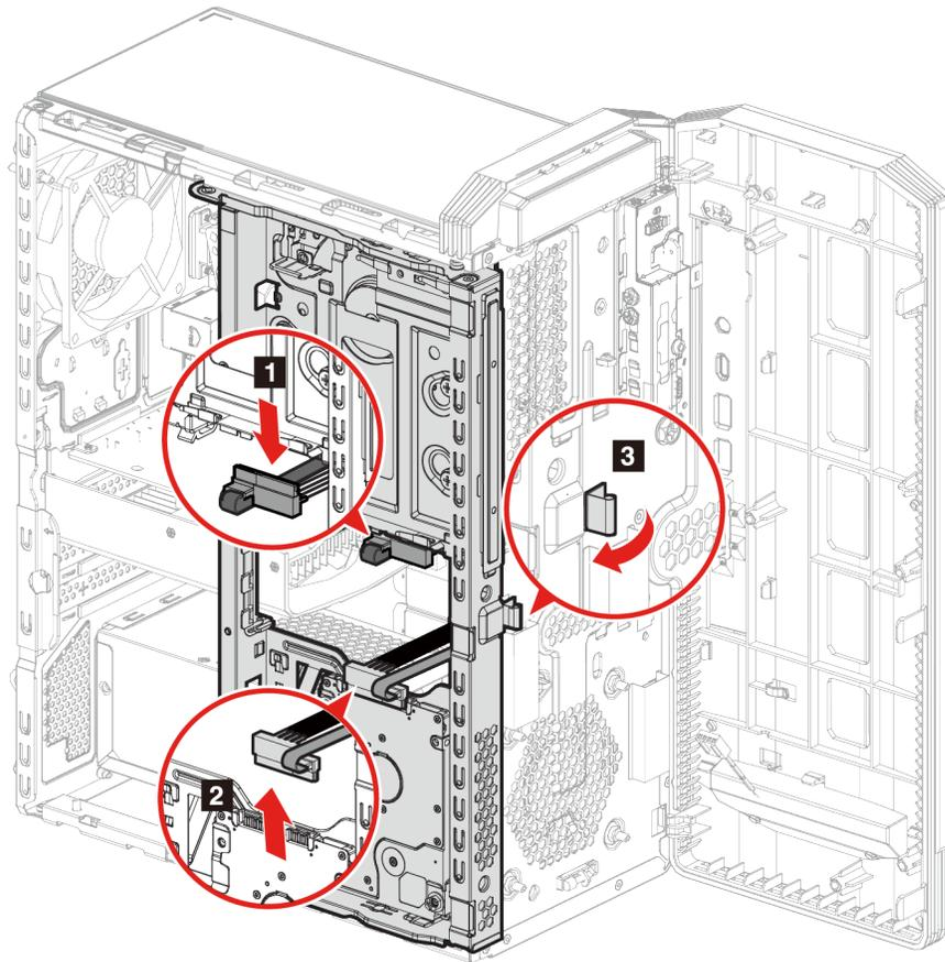
6. Far scorrere l'alloggiamento dell'unità di memorizzazione verso la parte anteriore del case e ruotarlo lontano dal case.
