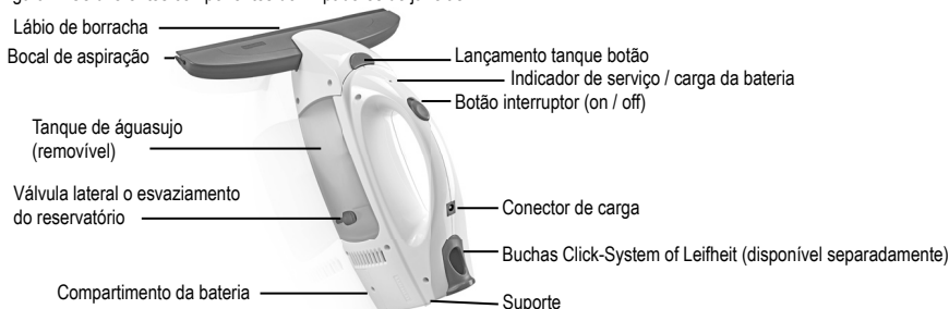
Figura 2: Os diferentes componentes do limpadores de janelas
