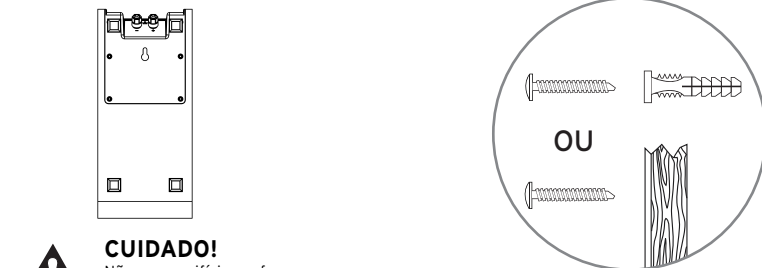
FIGURA 4 INSTALAÇÃO DAS CAIXAS ACÚSTICAS SURROUND EM PAREDE
