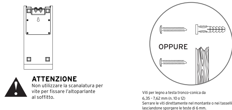
FIGURA 4 FISSAGGIO A PARETE DEGLI ALTOPARLANTI SURROUND
