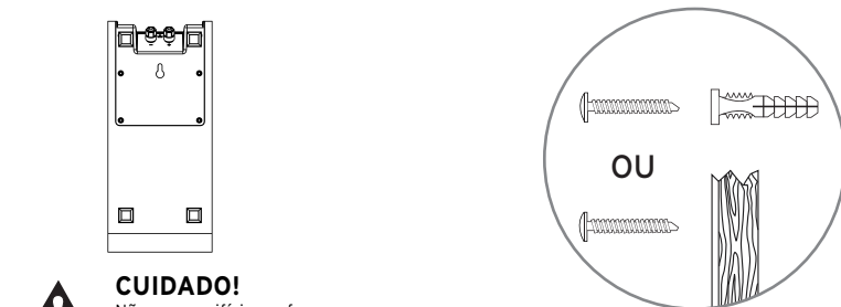
FIGURA 4 INSTALAÇÃO DAS CAIXAS ACÚSTICAS SURROUND EM PAREDE
