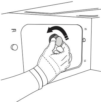
3. Sostituire la lampada e avvitare di nuovo il coperchio, facendo attenzione a rimontare correttamente le guarnizioni.
