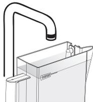
Prima di inserire il serbatoio nell'apposita cavità, è opportuno verificare che il tubo dell'acqua sia correttamente posizionato nell'incavo sul bordo superiore del serbatoio.
