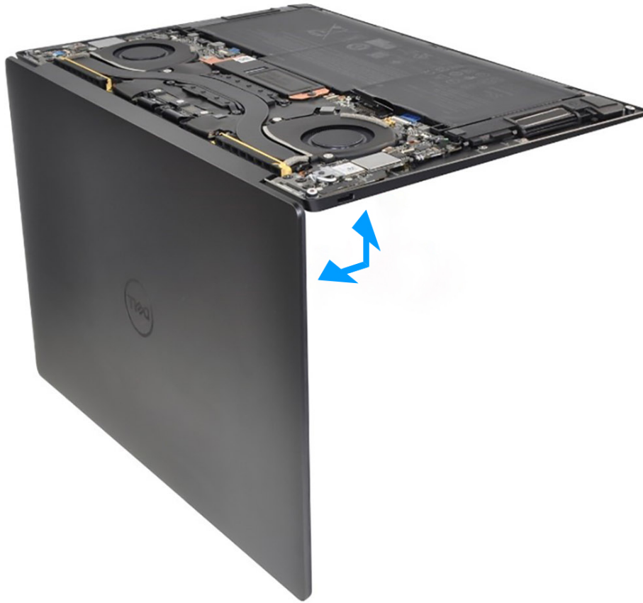
Figura 47. Aprire il gruppo del display a un'angolazione di 90 gradi
