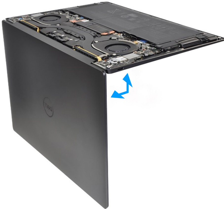
Figura 53. Aprire il gruppo del display a un'angolazione di 90 gradi
