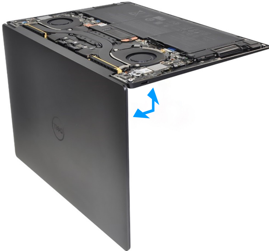
Figura 45. Aprire il gruppo del display a un'angolazione di 90 gradi
