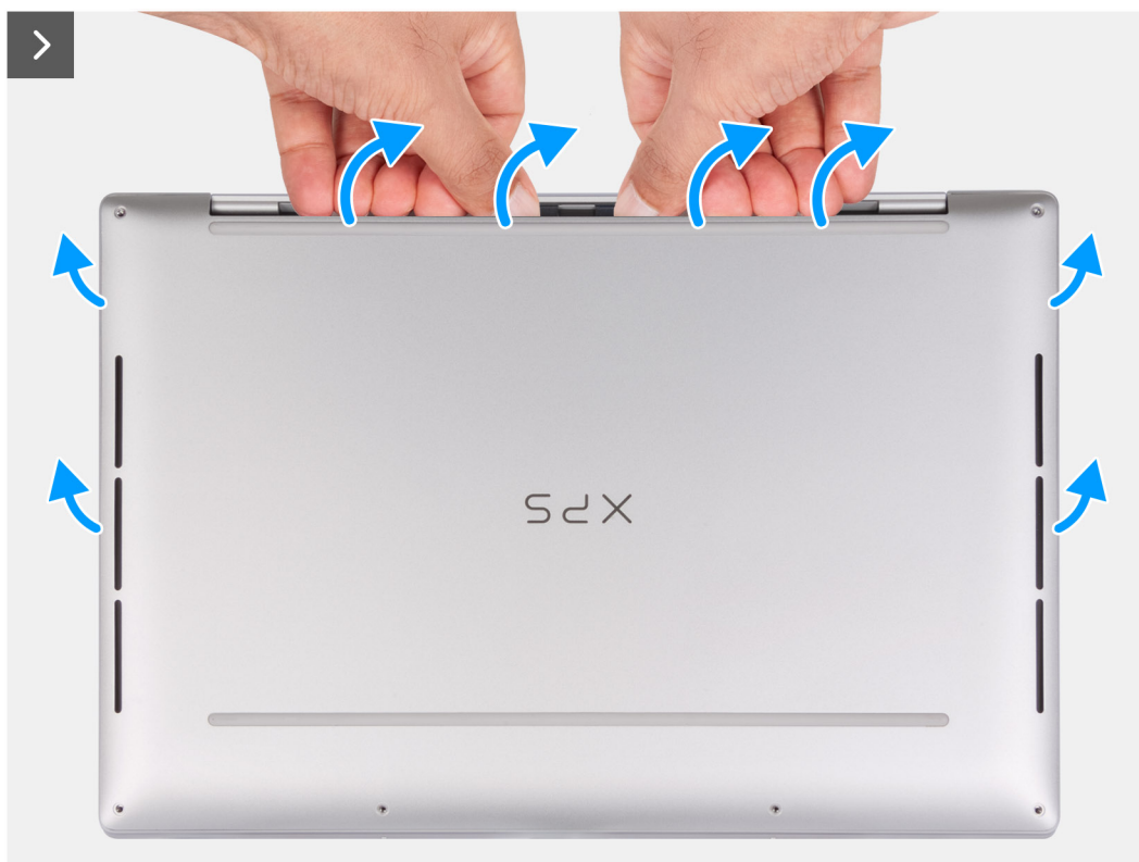
Figura 14. Rimozione del coperchio della base
