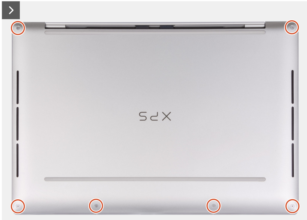
Figura 13. Rimozione del coperchio della base
