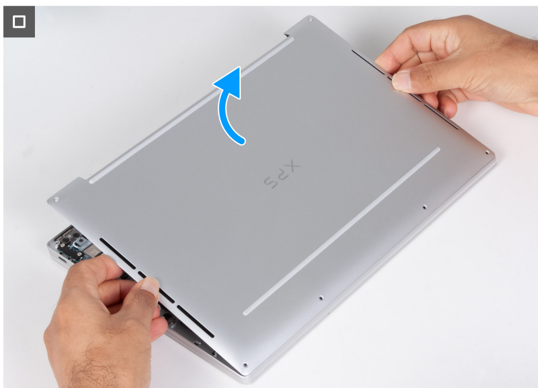
Figura 15. Rimozione del coperchio della base
