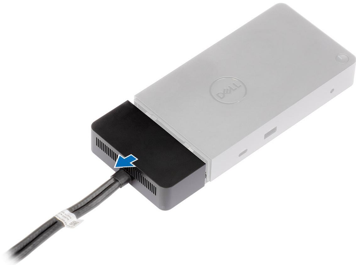
4. Sollevare e rimuovere il modulo del cavo USB Type-C dal relativo connettore all'interno della docking station.
