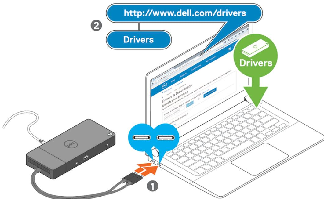
Figura 7. Collegare il connettore dual USB Type-C
