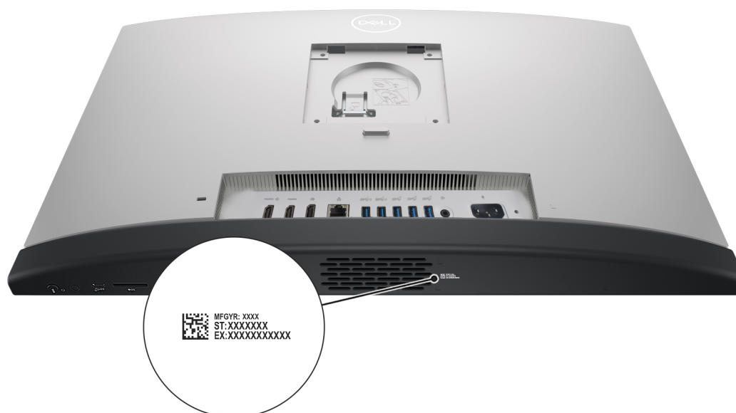
Figura 9. Posizione del codice di matricola di OptiPlex All-in-One Plus 7420
