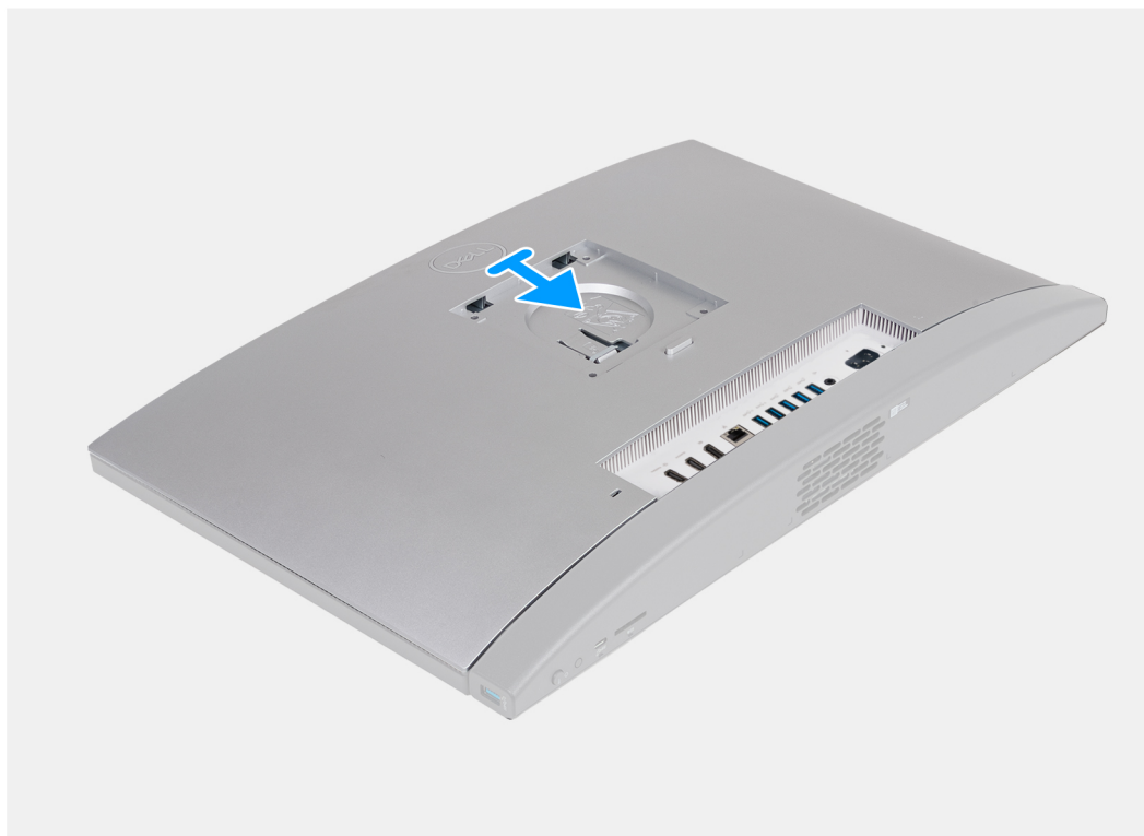
Figura 20. Installazione del coperchio posteriore
