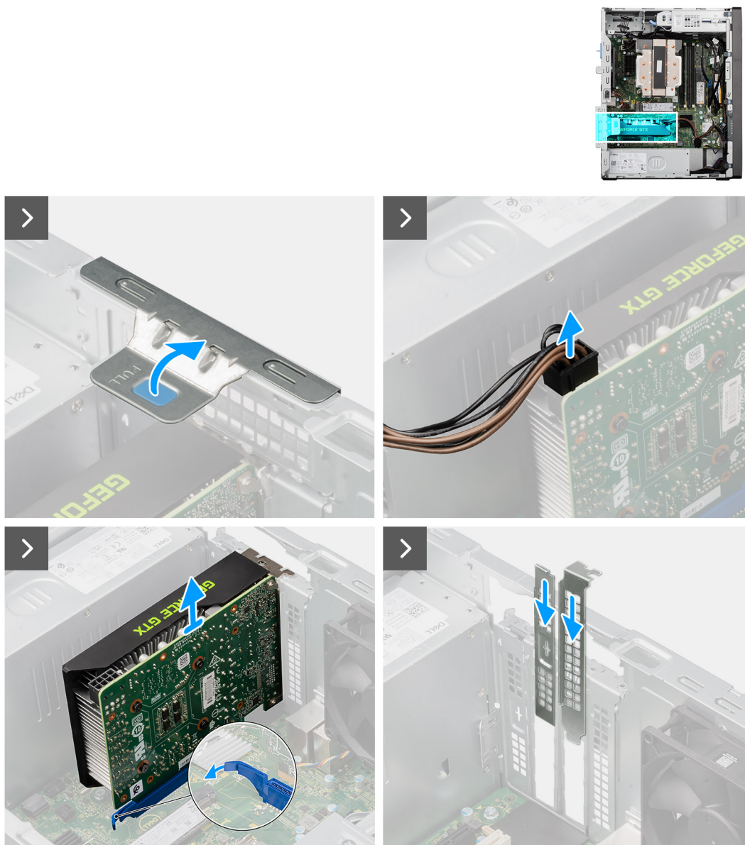
Figura 28. Rimozione della scheda grafica alimentata
