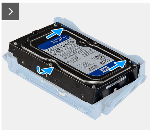
Figura 37. Installazione del disco rigido da 3,5 pollici
