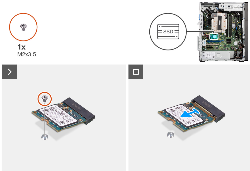
Figura 18. Rimozione dell'unità SSD M.2 2230
