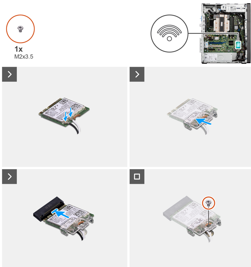
Figura 25. Installazione della scheda wireless
