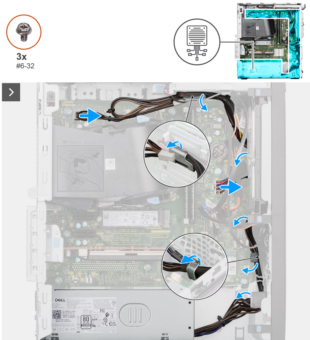
Figura 64. Rimozione dell'unità di alimentazione
