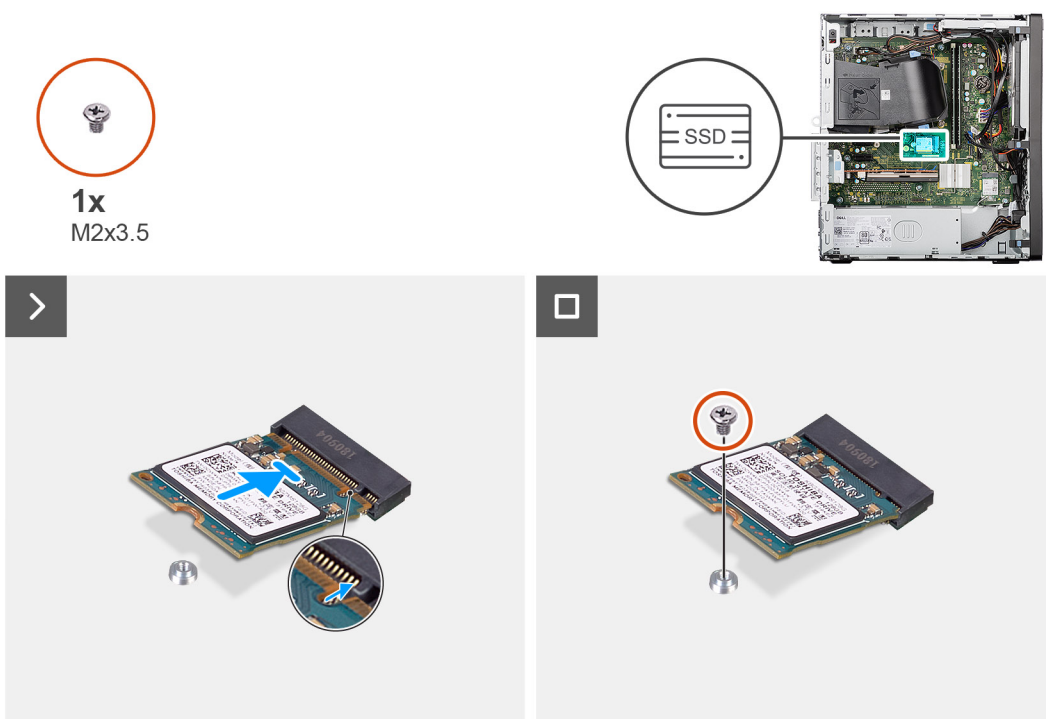
Figura 21. Installazione dell'unità SSD M.2 2230
