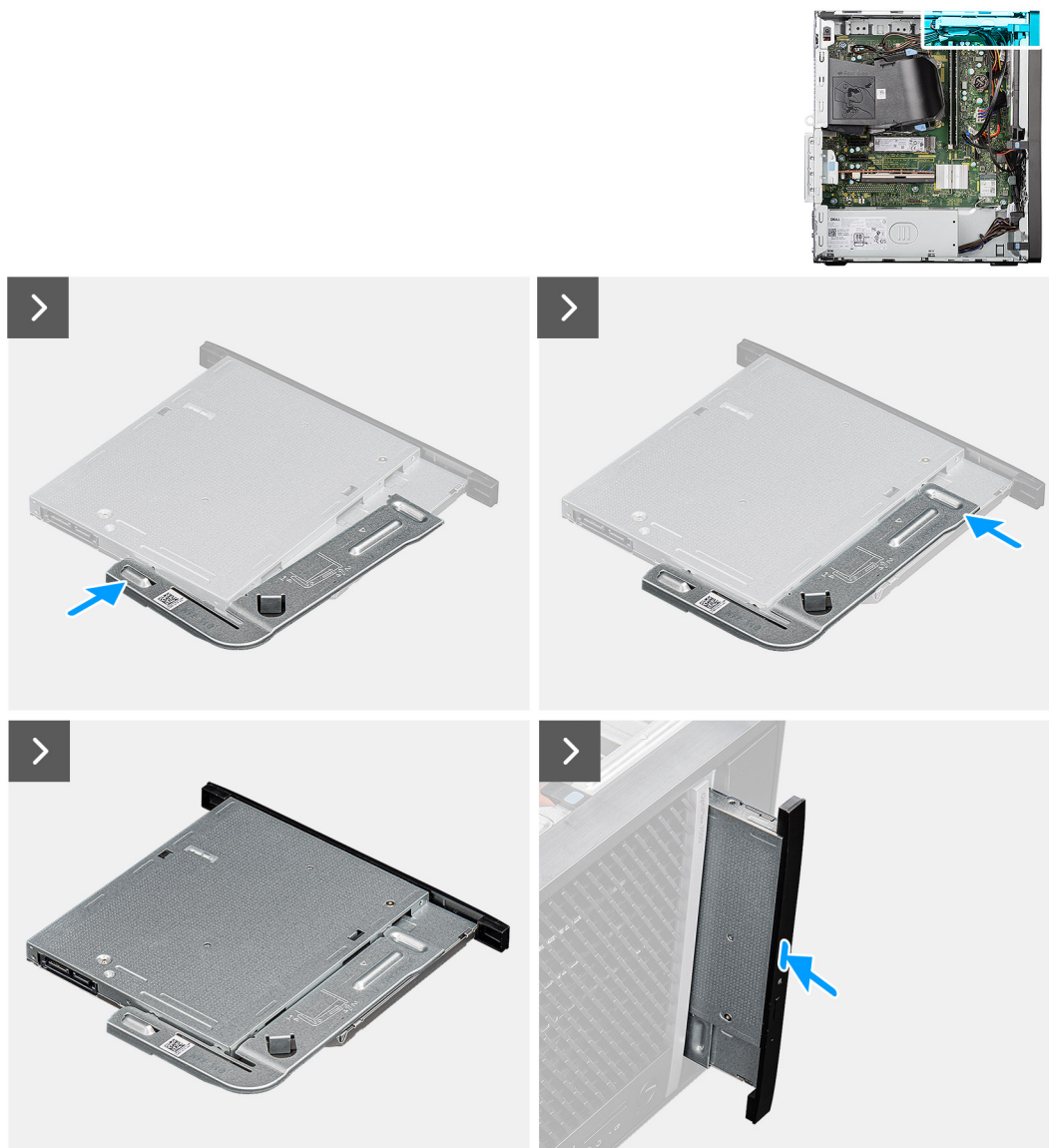
Figura 39. Installazione dell'unità ottica slim
