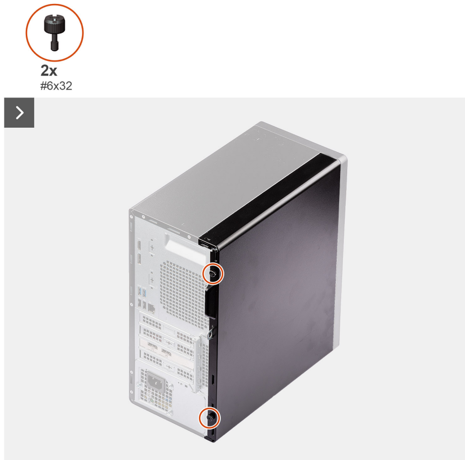
Figura 9. Rimozione del coperchio laterale
