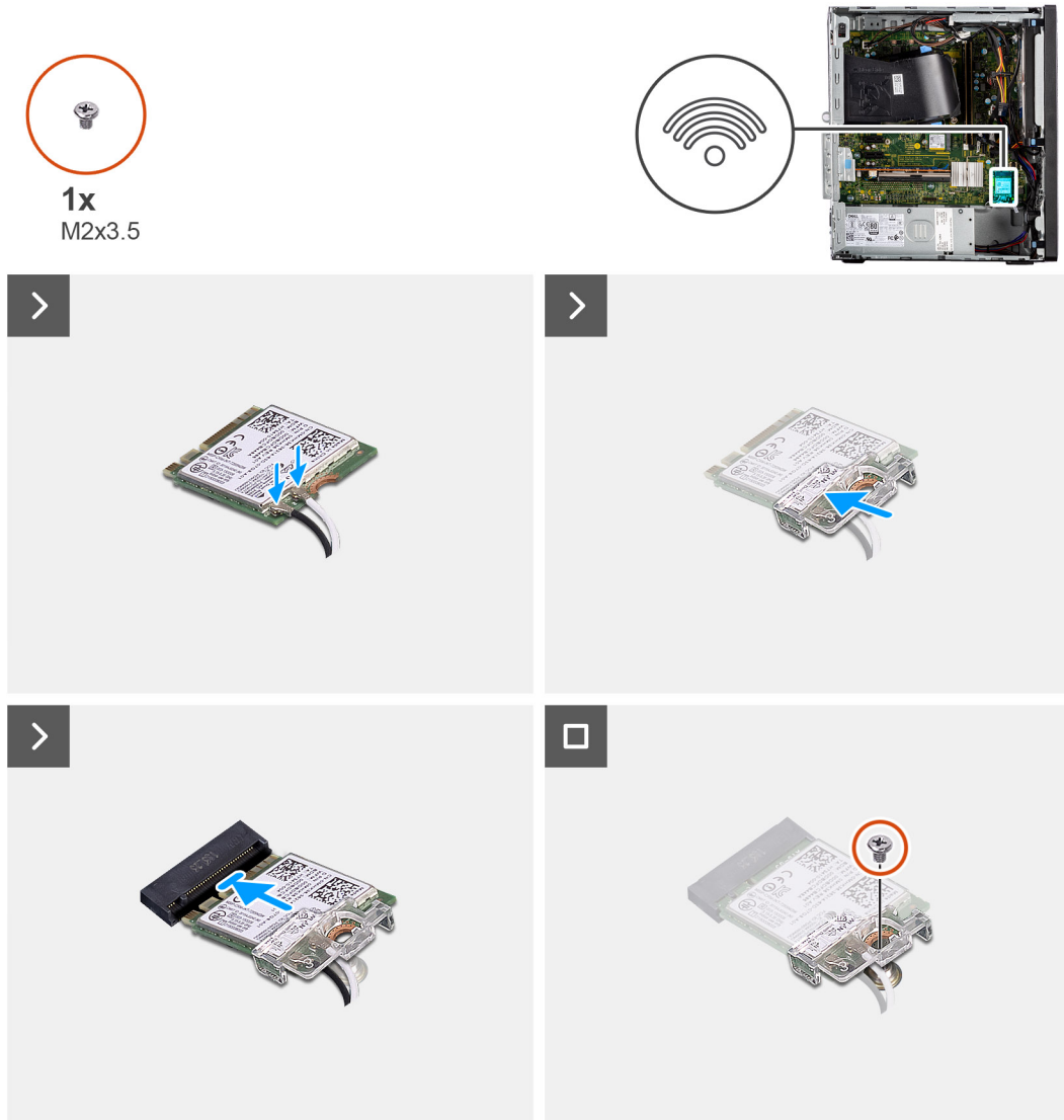
Figura 32. Installazione della scheda wireless
