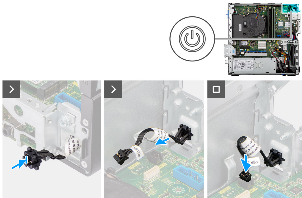
Figura 40. Installazione del pulsante di accensione
