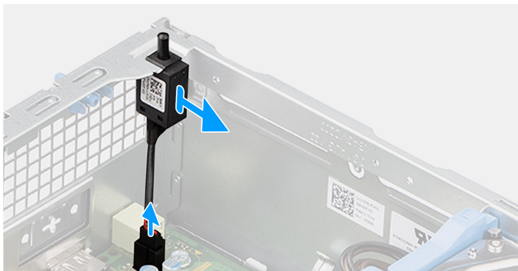
Figura 37. Rimozione dell'interruttore di intrusione
