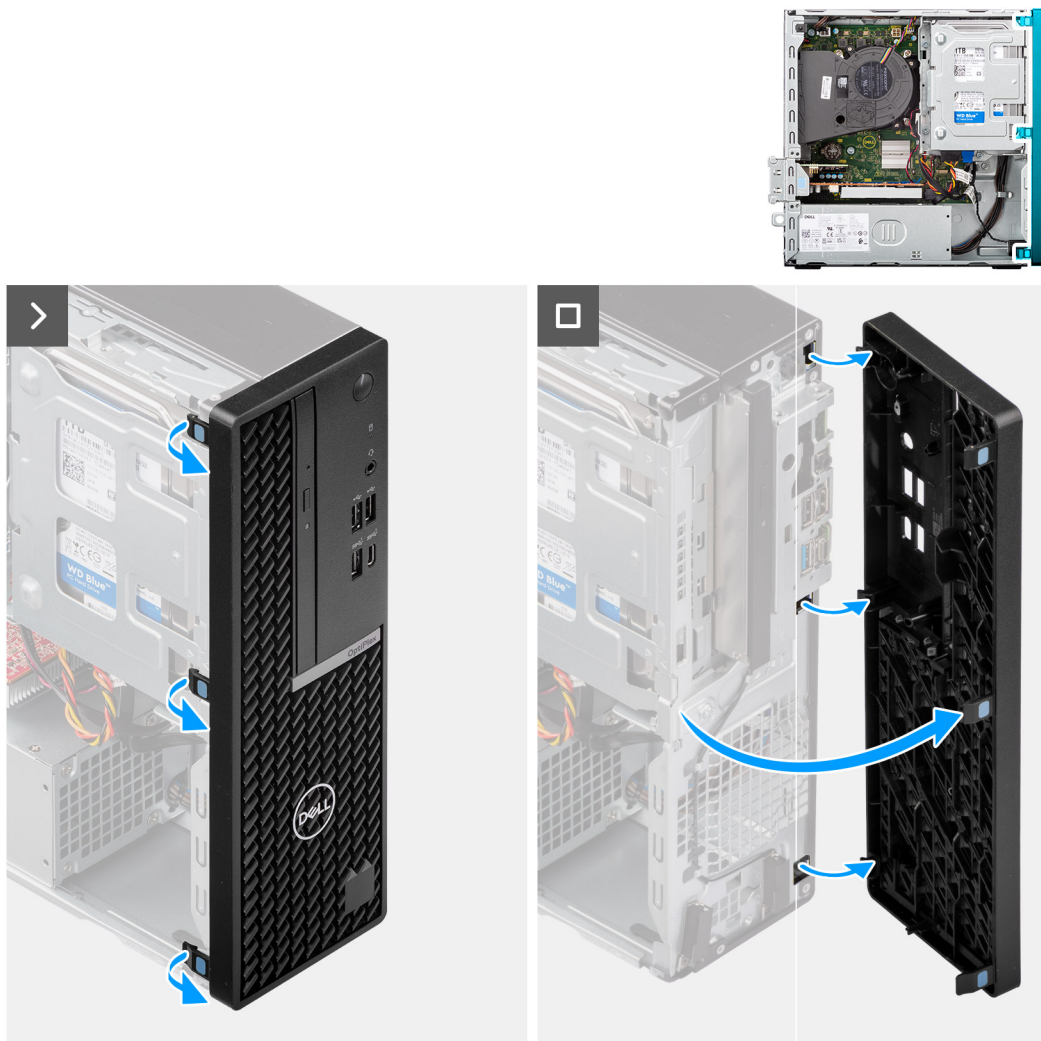
Figura 7. Rimozione del pannello anteriore
