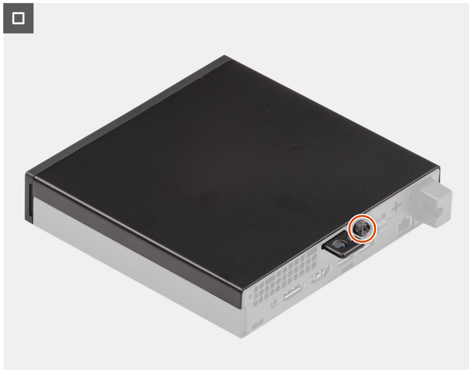
Figura 12. Installazione del coperchio laterale
