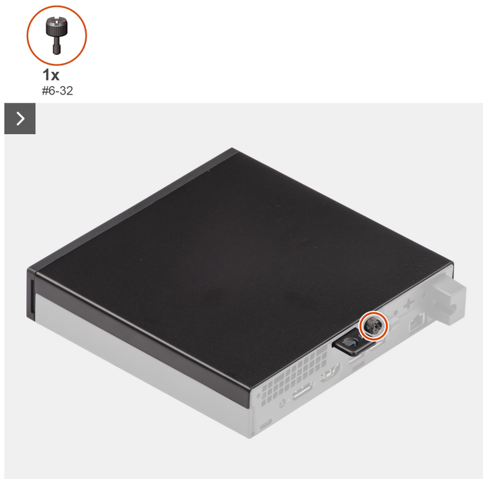
Figura 9. Rimozione del coperchio laterale
