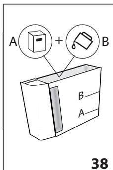
4. "DECALCIFICANTE (LIVELLO A) E ACQUA (LIVELLO B)" (fig. 38); Versare nel serbatoio acqua il decalcificante fino al livello A (corrispondente a una confezione da 100ml) impresso sul lato interno del serbatoio; quindi aggiungere acqua (un litro) fino a raggiungere il livello B; reinserire il serbatoio acqua. Premere la freccia di selezione corrispondente a "NEXT>";
