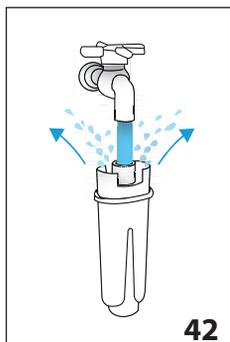
5. "FAR SCORRERE ACQUA FINCHE' FUORIESCE" (fig. 42): Per attivare il filtro, far scorrere dell'acqua di rubinetto nel foro del filtro come indicato in figura fintantoché l'acqua fuoriesce dalle aperture laterali per oltre un minuto. Premere la freccia di selezione in corrispondenza di "NEXT>";
