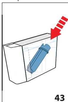
7. "IMMERGERE FILTRO LASCIANDO USCIRE L'ARIA" (fig. 43): Inserire il filtro nel serbatoio acqua e immergerlo completamente per una decina di secondi, inclinandolo e premendolo leggermente per permettere alle bolle d'aria di uscire. Premere la freccia di selezione in corrispondenza di "NEXT>";
