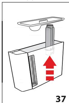
3. "RIMUOVERE FILTRO ACQUA" (fig. 37); estrarre il serbatoio acqua (A16), rimuovere il filtro acqua (C4) (se presente), svuotare il serbatoio acqua. Premere la freccia di selezione corrispondente a "NEXT>";
