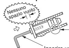
Non applicare olio lubrificante (olio refrigerante) al tappo di scarico al momento di inserirlo. L'applicazione di olio lubrificante sul tappo di scarico deteriorerebbe il tappo e darebbe luogo a delle perdite da quest'ultimo.
