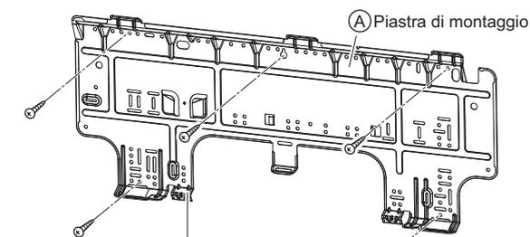
La piastra di montaggio deve essere installata su una parete in grado di sopportare il peso dell'unità interna.
