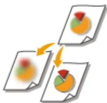
È possibile effettuare la scansione dell'immagine con contorni e linee chiare aumentando la nitidezza o ammorbidire l'immagine diminuendo la nitidezza. Utilizzare questa funzione quando si desidera ottenere testo e diagrammi sfocati più precisi oppure ridurre l'effetto moire (un motivo ondulato, tremolante) per rendere omogenea l'immagine finale.
