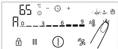
2. Na wyświetlaczu timera wyświetlane jest „65” jako najniższe ustawienie temperatury dla ustawienia niskiej temperatury. Dotykając klawisza +/- można zmienić ustawienie temperatury, zwiększając lub zmniejszając ją o 5 stopni.
