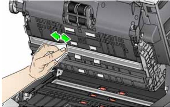
15. Pulire nuovamente l'area di esposizione superiore e inferiore utilizzando un panno Brilliantize (passaggio 2) o con un panno Staticide non completamente asciutto per rimuovere eventuali striature.
