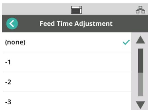
4. Se si sceglie -1, -2, -3 o -4, impostare la velocità dello scanner su *Massima velocità*. Vedere "Velocità" a pagina 37.
