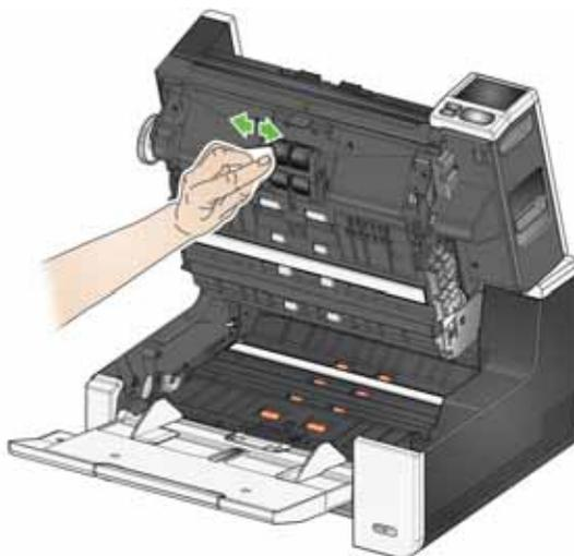
11. Ispezionare le gomme. Se il modulo di alimentazione mostra segni di usura o danni, sostituire le gomme o il modulo stesso. Vedere “Procedure di sostituzione” a pagina 58.
