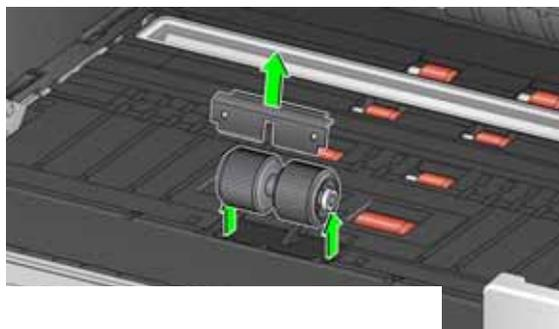
6. Ruotare manualmente e pulire le gomme del rullo separatore con un apposito tampone. Per ottenere risultati ottimali, pulire le gomme parallelamente alle nervature, in modo da rimuovere tutti i residui presenti tra le stesse.
