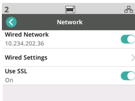
Se si utilizza una Rete cablata, è possibile scegliere tra una configurazione dell'indirizzo di rete Automatica e Manuale.
