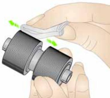
7. Ispezionare le gomme. In presenza di usura o danni, sostituire le gomme o il rullo separatore. Vedere “Procedure di sostituzione” a pagina 58.
