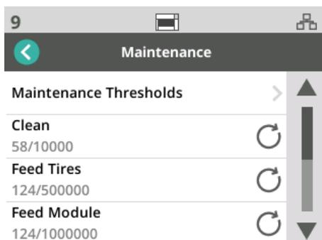
Ciascuna voce nel menu dei misuratori visualizza il numero di scansioni effettuate a partire dall'ultima pulizia o sostituzione eseguita e il numero massimo di scansioni consigliato prima di effettuare la prossima pulizia o sostituzione. Nell'esempio sovra riportato sono state eseguite 124 scansioni dall'ultima sostituzione del Modulo di alimentazione; si consiglia un massimo di 1.000.000 di scansioni prima di effettuare una nuova sostituzione.
