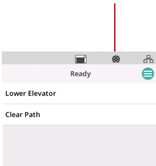
occorre provvedere alla pulizia dello scanner o alla sostituzione dei materiali di consumo (rulli, gomme, ecc.). Vedere “Manutenzione” a pagina 30. Questa icona viene visualizzata solo alla scadenza di uno dei misuratori di manutenzione.
