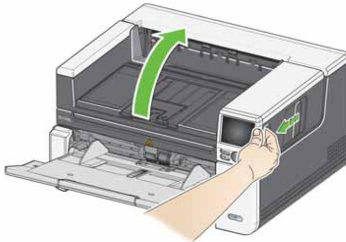
4. Dopo aver pulito lo scanner o sostituito un componente, chiudere il coperchio dello scanner con entrambe le mani.
