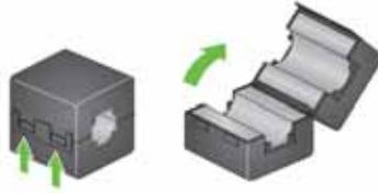
2. Avvolgere il cavo Ethernet intorno al nucleo in ferrite come mostrato. Posizionarlo a circa 3 pollici/7,6 cm dall'estremità del cavo Ethernet che verrà collegato allo scanner.
