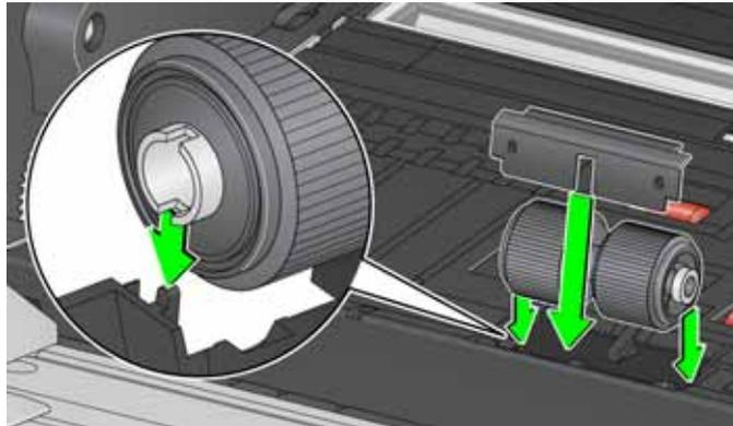
4. Reinstallare il tampone pre-separatore. Accertarsi che entri ad incastro.
