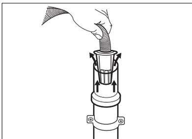
5. **Senza la guida del tubo flessibile in plastica, verso il sifone di un lavandino** - Fissare il tubo al sifone, e serrarlo con una pinza. Fare riferimento all'immagine.
